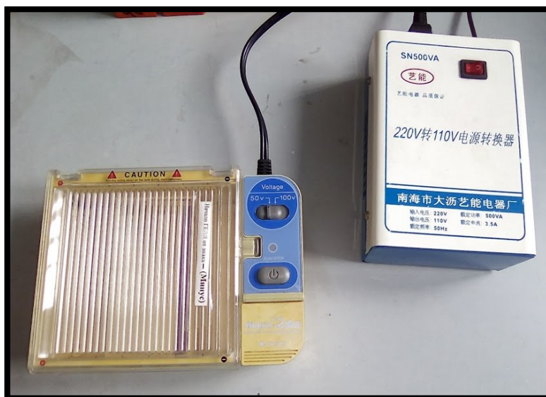
Рис. 4 Электрофорез Mupid-9plus для разделения продуктов ПЦР
