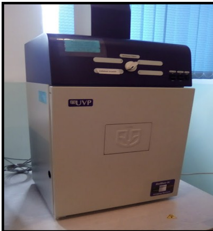
Рис. 5 UVP Имидженситометр (Benchtop- UV Transilluminator) для идентификации генотипов и аллелей
