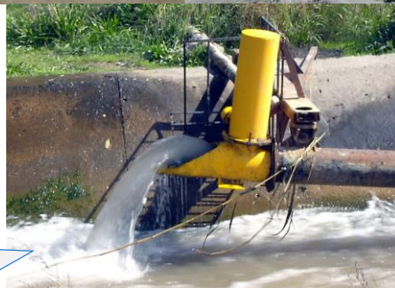
«Гидротаран». Используются на водозаборах в Кыргызстане и стран СНГ. Автор Рогозин Г. В.
